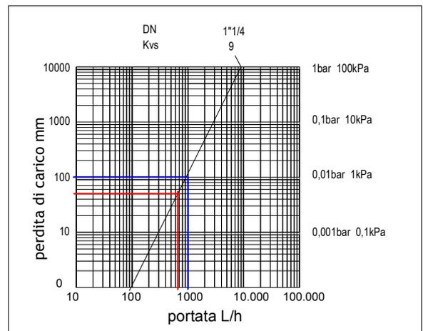
Nei diagrammi delle valvole termo statizzabili per la Caleffi ne specifica la perdita di carico il Kv a posizioni intermedie della regolazione ( condizione comune anche per altri produttori).
