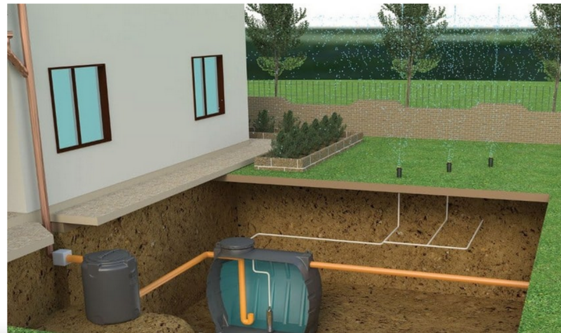
sistema di recupero acqua piovana ©CORDIVARI
